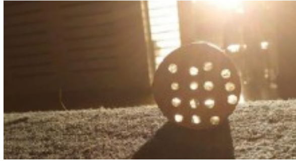
Figura 4. Probeta cilíndrica con vidrios cilíndricos al contraste con la luz natural.
